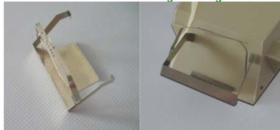
Bughalterung entlang der Biegekanten abkanten. Die beiden Langteile für die Darstellung des Befestigungsriemens sind je nach Beladungsgut passend zu kürzen und am Ende mit einer Biegung zur Befestigung an der Bughalterung wie dargestellt zu versehen. Die Bughalterung wird am Wannenoberteil vorne befestigt und kann mit 4 maßstäblichen Benzinkanistern o.a. beladen werden.
