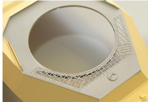
Das Motorgitter passt für das SdKfz 223. Im Oberteil entlang des geprägten Randes mit einer Laubsäge passend ausschneiden und säubern. Anschließend mit Zweikomponentenkleber das Ätzteil einsetzen. Das beigegefügte quadratische Blech mit Loch kann bei Einbau des Luftfilters das Gussteil P39 ersetzen.
