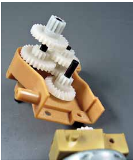
Das fertig zusammengebaute Getriebe mit Motor
