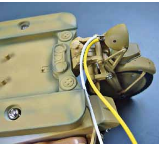
Die angelötete LED im Scheinwerfer. Auch hier gilt: Farbe drüber und man sieht kaum noch etwas
