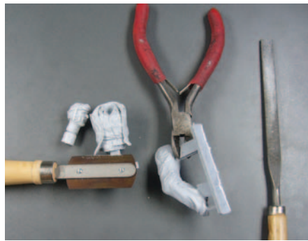
Werkzeuge zum Entfernen der Gießäste. Bei größeren Teilen ist auch der vorsichtige Einsatz eines Tellerschleifers eine große Hilfe
